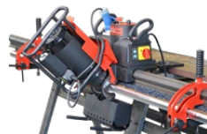
ABM-28 • Fasenbreite bis 35 mm • Plandrehen, Ober und Unterfase • automatischer Vorschub • J-Fasen (Option) • Entplattierung (Option)
