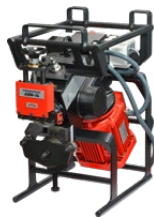
ABM-14 • Fasenbreite bis 14 mm • Faswinkel 30° (Option): 22,5°, 25°, 35°, 37,5°, 45° • Ober und Unterfase
